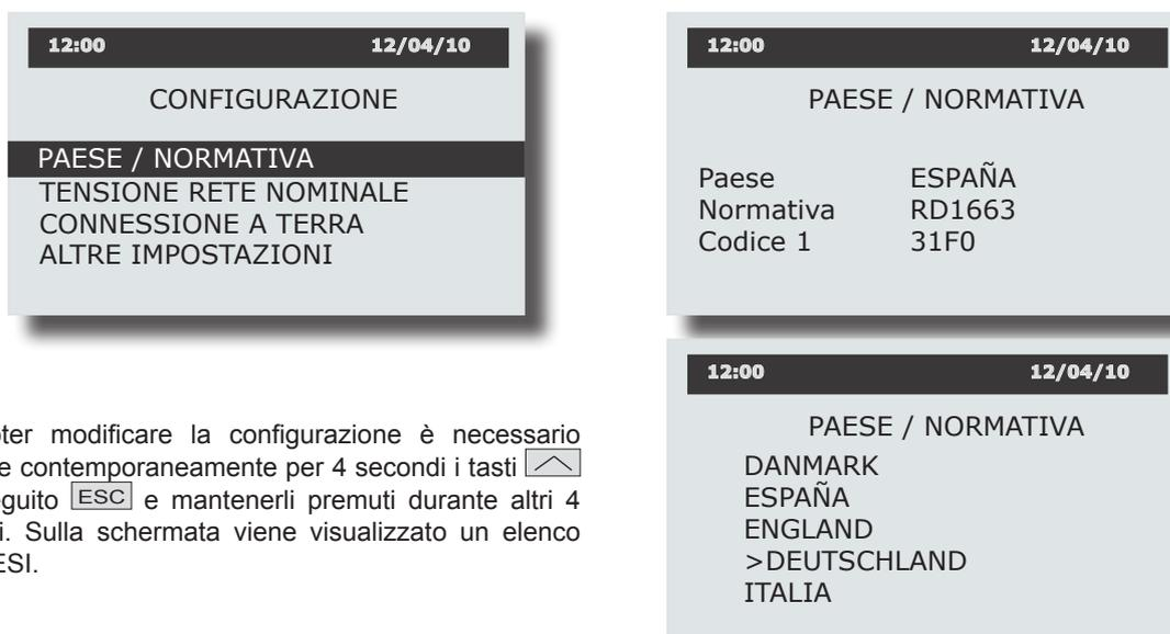
Per poter modificare la configurazione è necessario premere contemporaneamente per 4 secondi i tasti e in seguito **ESC** e mantenerli premuti durante altri 4 secondi. Sulla schermata viene visualizzato un elenco dei PAESI.
