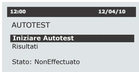
Una volta dentro al menu, è possibile realizzare una prova sulle protezioni di tensione e frequenza modificandone la soglia e verificando il corretto disinserimento. Per farlo utilizzare i tasti  e  per accedere alle funzioni START AUTOTEST e RISULTATI. Al tempo stesso, viene visualizzato sullo sfondo del display lo stato del processo. Premere  per iniziare l'AUTOTEST.
